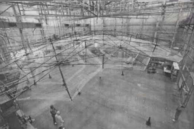
きく8号のアンテナを展開したところ 写真提供 JAXA
