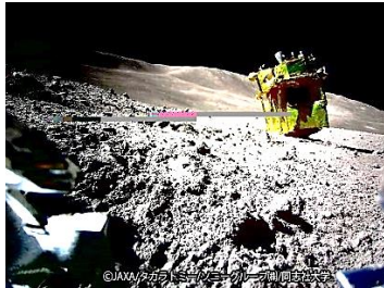
←SLIMの着陸直前に放出さ れたLEV-1とLEV-2。手のひ らに乗るロボットLEV- 2(SORA-Q)が撮影し、そのデ ータがLEV-1を経由し、地球 に送信された画像。
